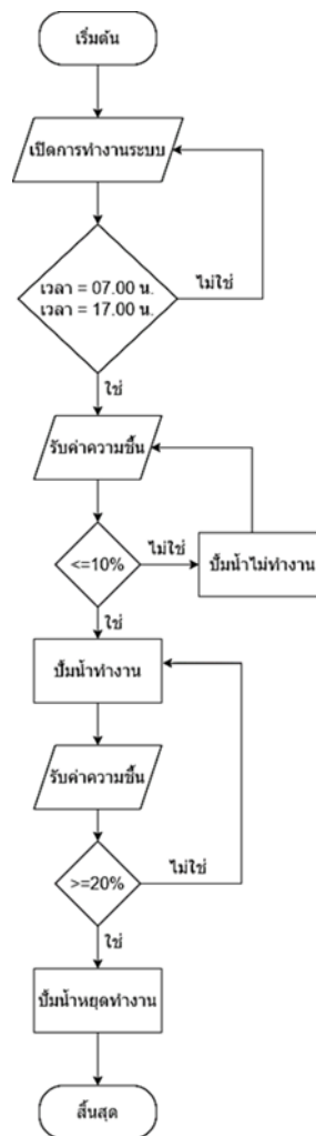
ภาพที่ 1 Flowchart ระบบควบคุมการรดน้ำ
