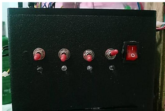
ภาพที่ 7 LED แสดงสถานการณ์ทำงานต่างๆของระบบแมนนวล
